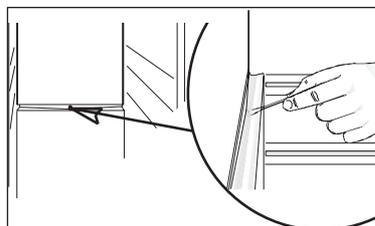
Снимите вентиляционную решётку (см. выше) и вычистите пространство под холодильником с помощью пылесоса. Отодвиньте холодильник от стены и пропылесосьте пространство за ним, а также охлаждательную систему и компрессор.
